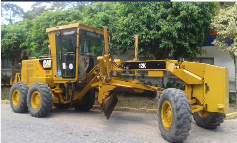
Motoniveladora 12K CAT
